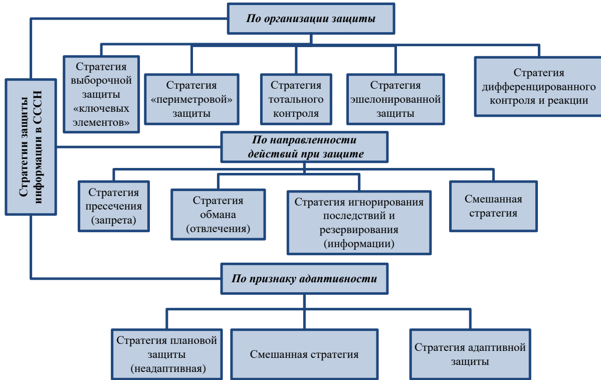
Рисунок 1 – Классификация стратегий защиты в СССН Figure 1 – Classification of protection strategies in the SSSN
