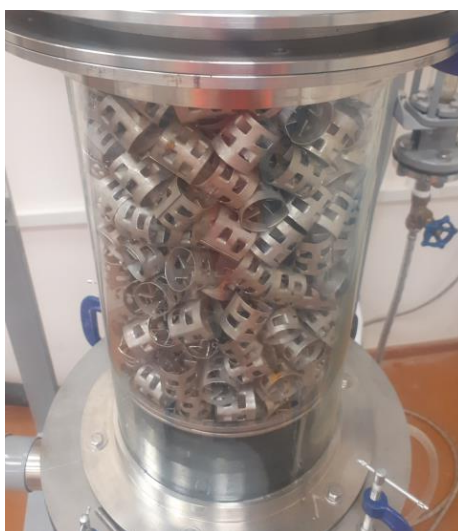
Рисунок 4 – Фото экспериментального модуля для исследования параметров структуры потока фильтрационного течения паровой фазы через насадочный блок массообменного аппарата (для процесса ректификации) (насадка – кольца Палля 25x25x1мм)
