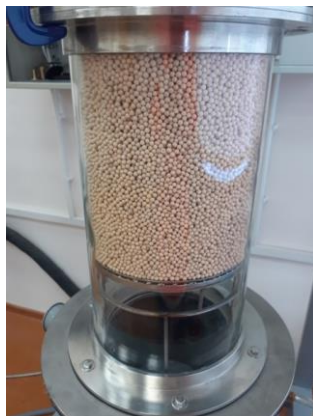
Рисунок 1 – Фото экспериментального модуля для исследования параметров структуры потока фильтрационного течения газовой фазы через слой сорбента – цеолит СаА (гранулы d=3-5\text{мм} ) (диаметр модуля – 200мм, высота модуля 300мм)
