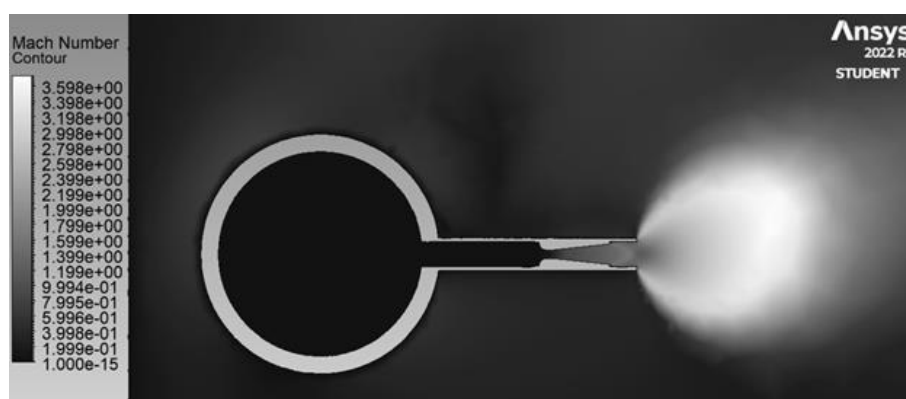
Рисунок 5 – Контур распределения числа Маха для режима истечения с разрывом трубопровода Figure 5 – Mach number distribution contour for the flow mode with pipeline rupture
