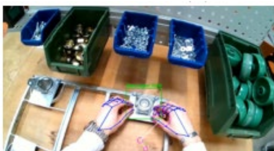
Рисунок 3 – Совмещенная визуализация детекции объектов, рук и точки фиксации взгляда Figure 3 – Combined visualization of object detection, hand detection and gaze fixation point
