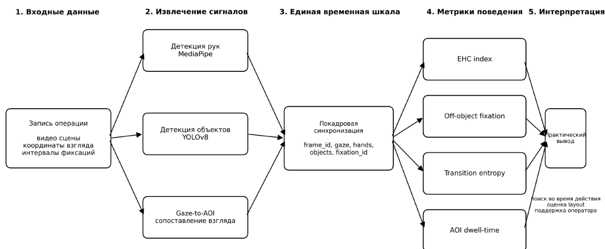
Рисунок 1 – Общая схема автоматизированной обработки данных: от записи операции к покадровой синхронизации и расчету поведенческих показателей
