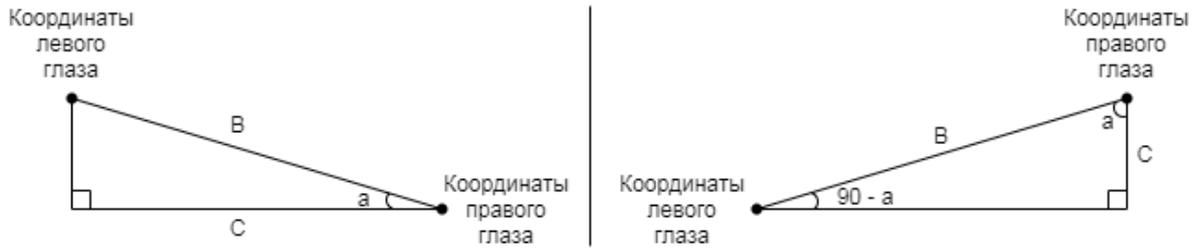
Рисунок 4 – Схема поиска угла  $\alpha$  в зависимости от расположения глаз
