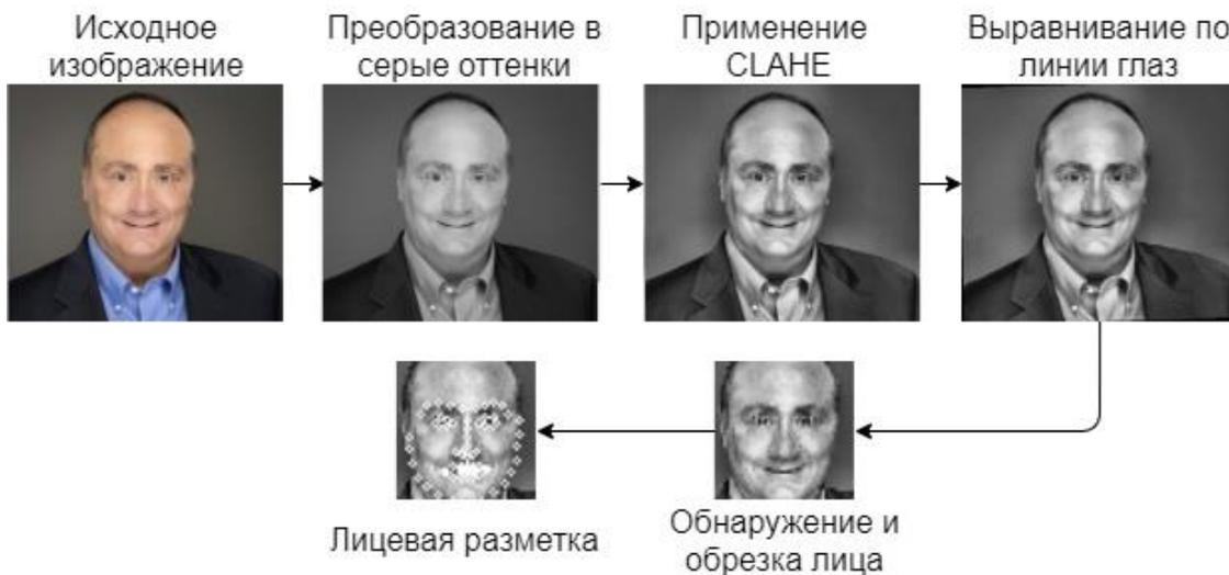
Рисунок 5 – Схема этапа предобработки системы
