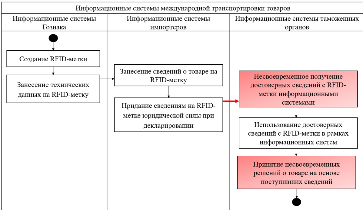
Рисунок 2 – Модель несвоевременного поступления информации с RFID-меток в информационные системы международной транспортировки товаров Figure 2 – Model of untimely receipt of information from RFID tags into information systems of international transportation of goods
