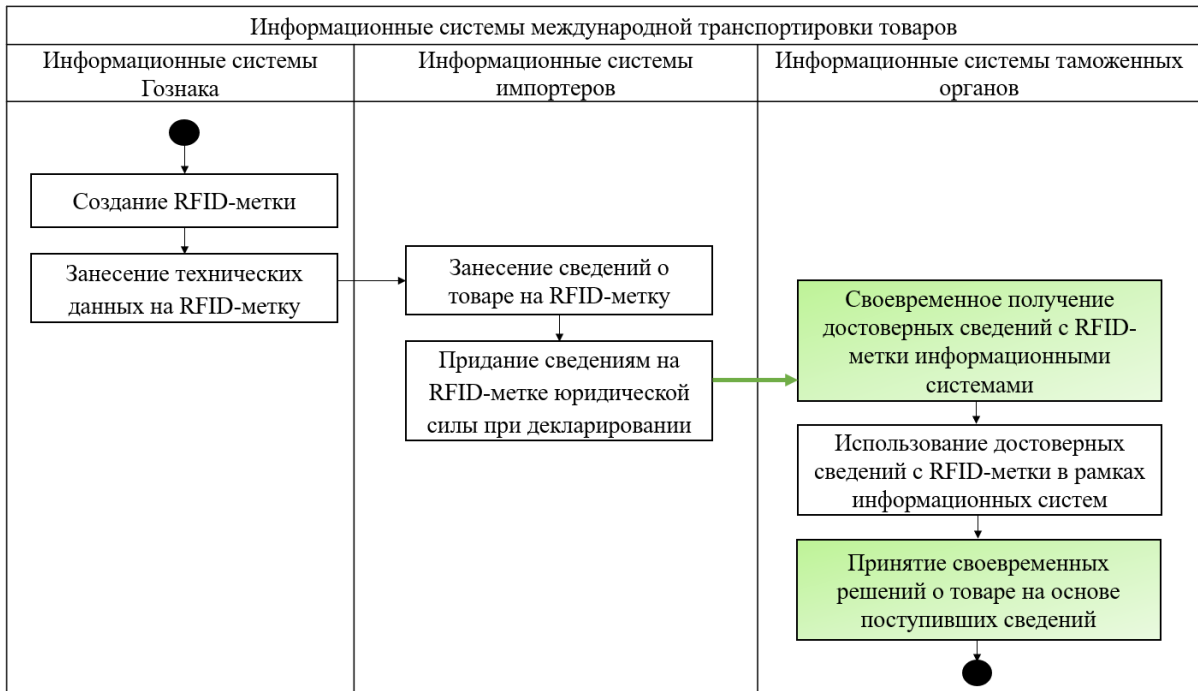
Рисунок 1 – Требуемая модель своевременного поступления информации с RFID-меток в информационные системы международной транспортировки товаров Figure 1 – The required model of the timely receipt of information from RFID tags into information systems for the international transportation of goods
