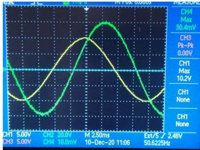
Рисунок 1 – Визуализация синусоидального напряжения, поданного на катушку
