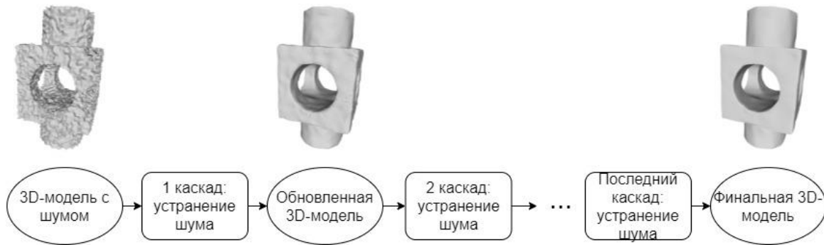
Рисунок 2 – Каскадная схема устранения шума Figure 2 – Cascaded noise elimination scheme
