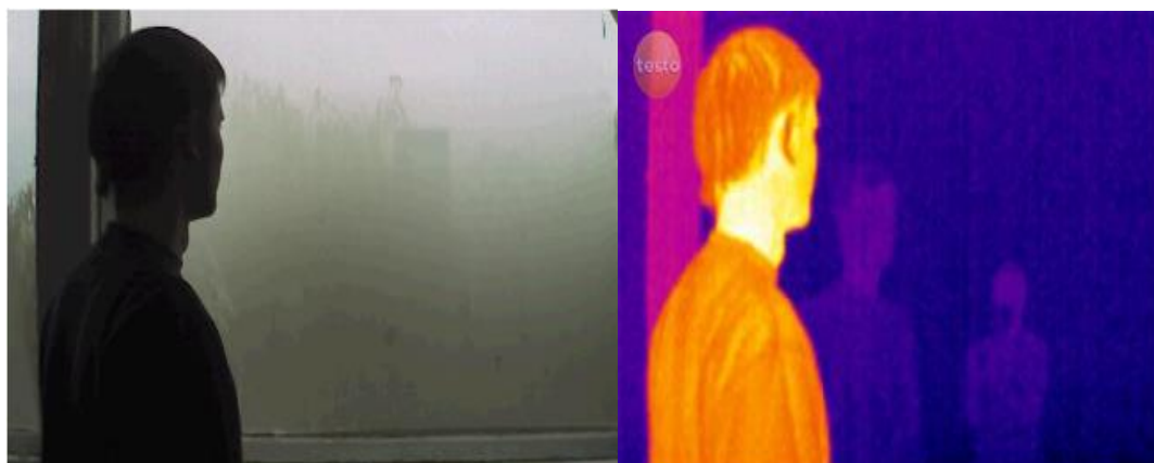
Рисунок 2 – Исходные изображения второй части испытаний. А – видеоизображение; Б – тепловизионное изображение Figure 2 – Initial images of the second part of the tests. A – video image; B – thermal imaging image
