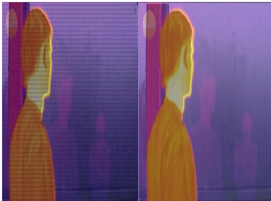
Рисунок 4 – Изображения второй части испытаний. А – совмещенное изображение Б – обработанное изображение Figure 4 – Images of the second part of the tests. A – composite image B – processed image
