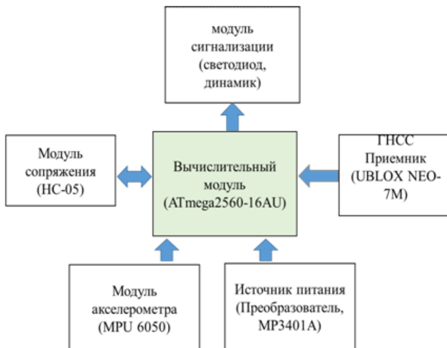
Рисунок 1 – Структурная схема бортового устройства контроля разбега самолета
