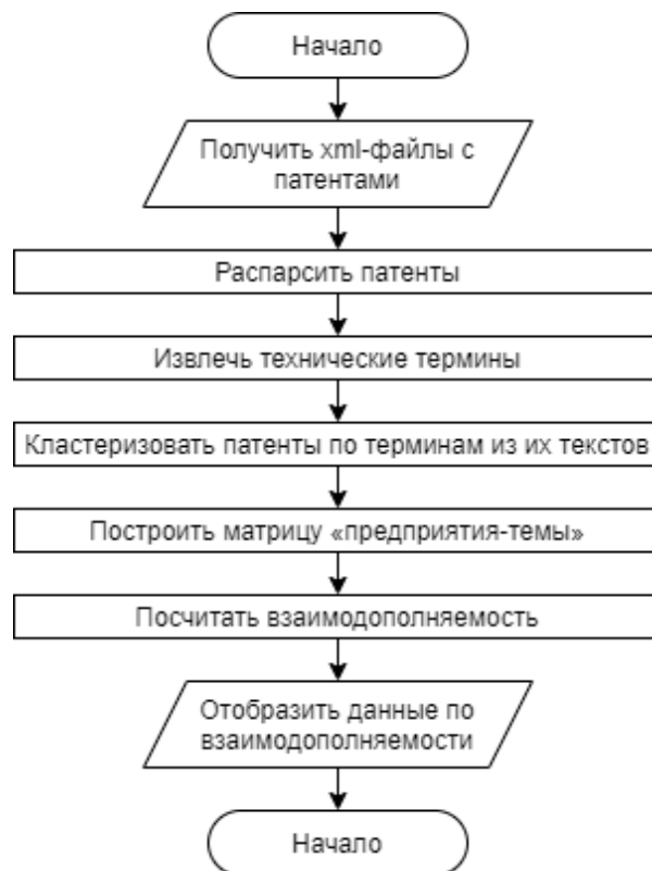
Рисунок 1 – Общий алгоритм процесса выявления технологической взаимодополняемости предприятий на основе кластеризации патентных документов USPTO
