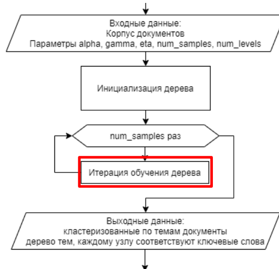
Рисунок 2 – Алгоритм кластеризации патентного массива на основе метода hLDA Figure 2 – Patent database clustering algorithm based on the hLDA method
