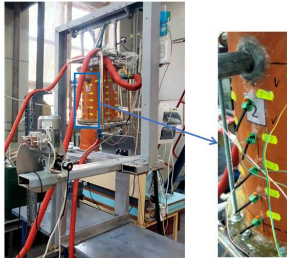
Рисунок 1 – Общий вид экспериментального стенда и качающейся платформы (слева), местный вид на контактные группы термозондов (справа)
