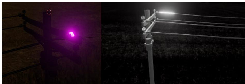
Рисунок 6 – Примеры постобработки полученных изображений для имитации УФ (слева) и ИК (справа) спектра Figure 6 – Examples of post-processing of the obtained images to simulate the UV (left) and IR (right) spectra
