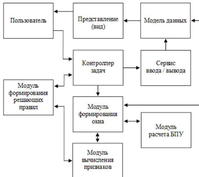
Рисунок 9 – Модульная структура программного обеспечения для построения «слабых» классификаторов
