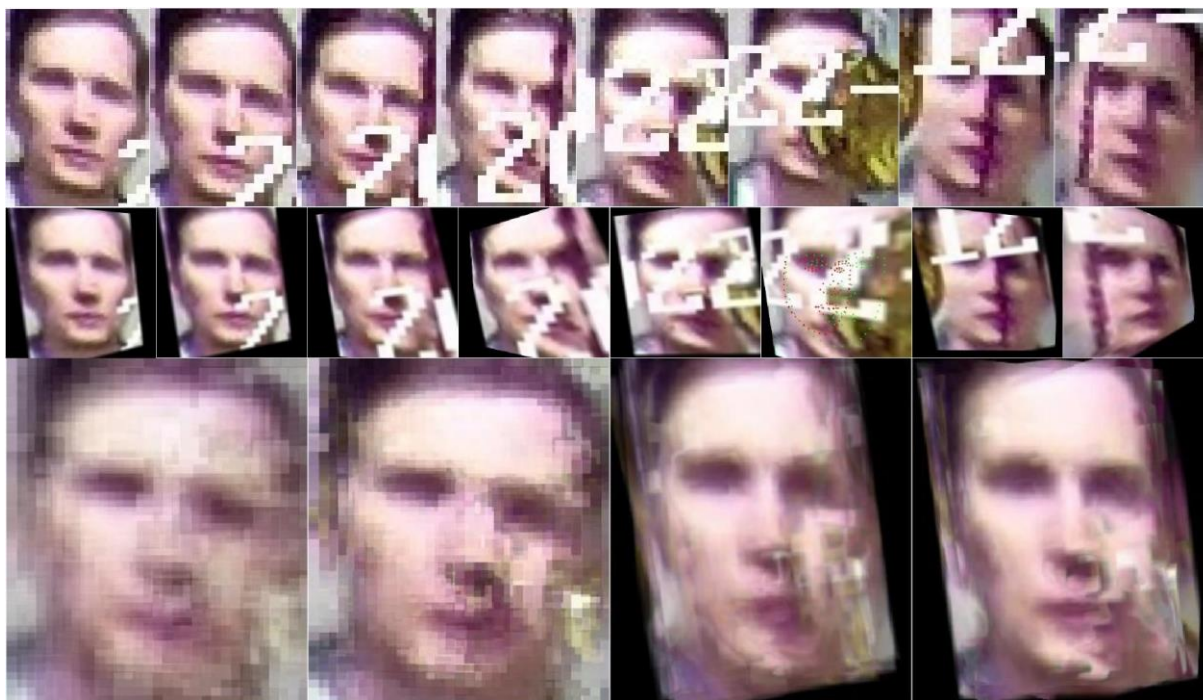
Рисунок 5 – Апробация усреднения лиц при окклюзиях, построчно сверху вниз: исходные изображения (~32x44); выравненные в двумерном пространстве (6 изображение – выброс); среднее, медиана, медиана при 1D трансформации, медиана при 2D трансформации Figure 5 – Practice of facial approximation with occlusions, top-down row: original images (~32x44); adjusted in 2-dimensional (6 image – outlier); average, median, median at 1-dimensional corrections, median at 2-dimensional corrections
