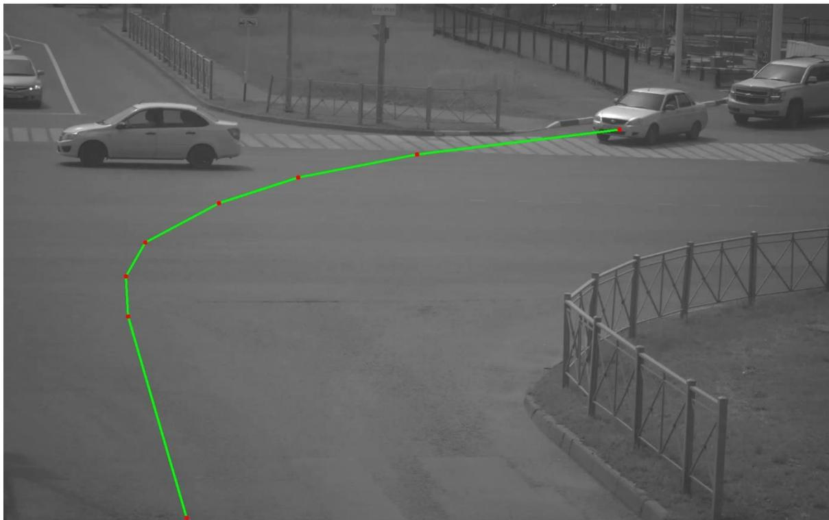
Рисунок 8 – Аппроксимация и прореживание траектории с помощью алгоритма Рамера-Дугласа-Пекера (N=8)
