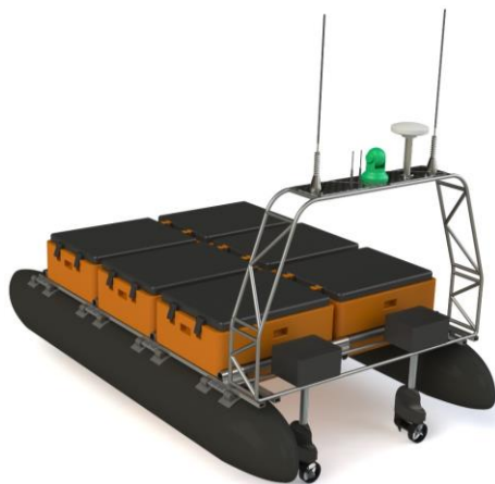
Рисунок 7 – Возможная компоновка катамарана для проведения натурных морских испытаний алгоритмов расхождения
