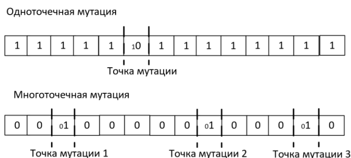
Рисунок 6 – Пример одноточечной и многоточечной мутации Figure 6 – Example of single-point and multi-point mutation
