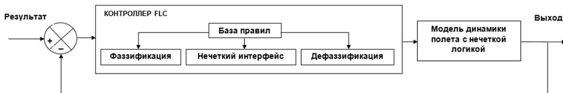
Рисунок 2 – Контроллер нечеткой логики, используемый для динамики полета «Форпост-Р»
