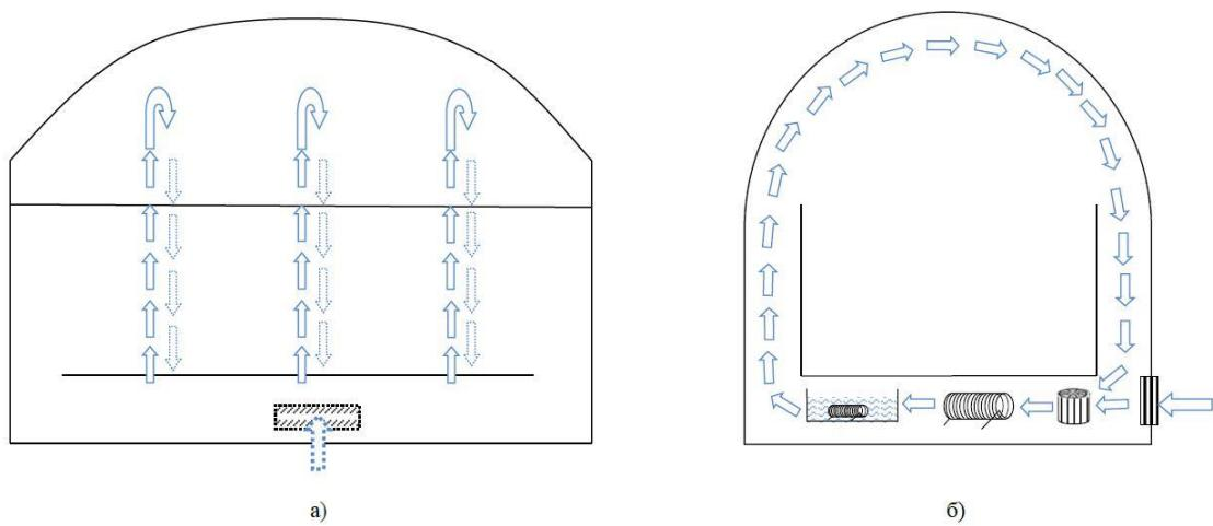
Рисунок 3 – Циркуляция воздушных потоков: передняя стенка – купол – задняя стенка
