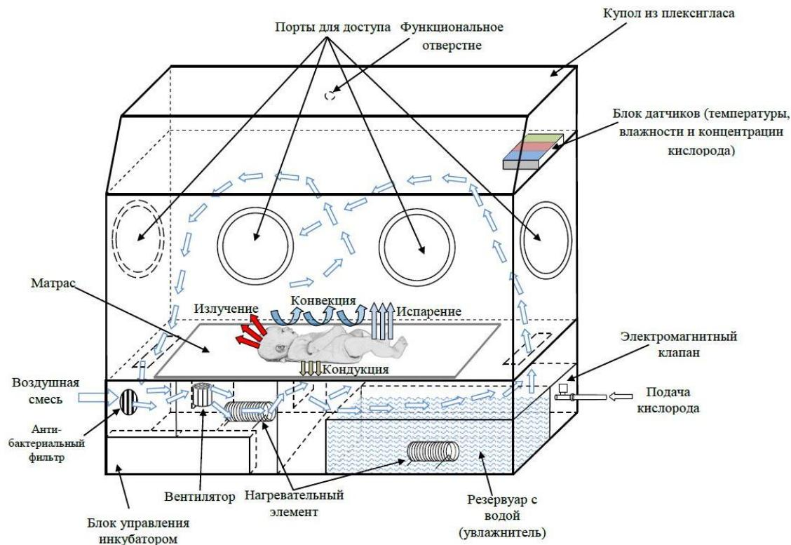
Рисунок 1 – Обобщенный вид конвекционного НИ для новорожденных
