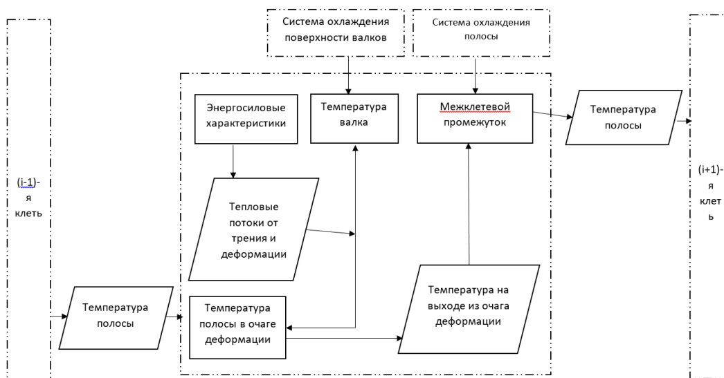
Рисунок 2 – Алгоритм моделирования температуры в клет Figure 2 – Algorithm for modeling the temperature in the stand
