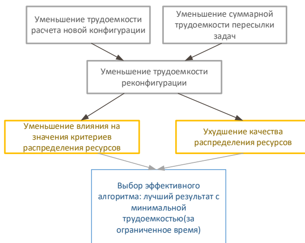
Рисунок 4 – Уменьшение противоречия между минимизацией трудоемкости вычислительной процедуры и ухудшением качества получаемого решения
