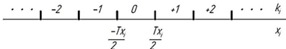
Рисунок 1 – Схема расположения и нумерация интервалов групповых допусков
