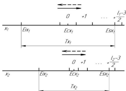
Рисунок 2 – Схема, поясняющая процедуру расчета границ селективных групп
