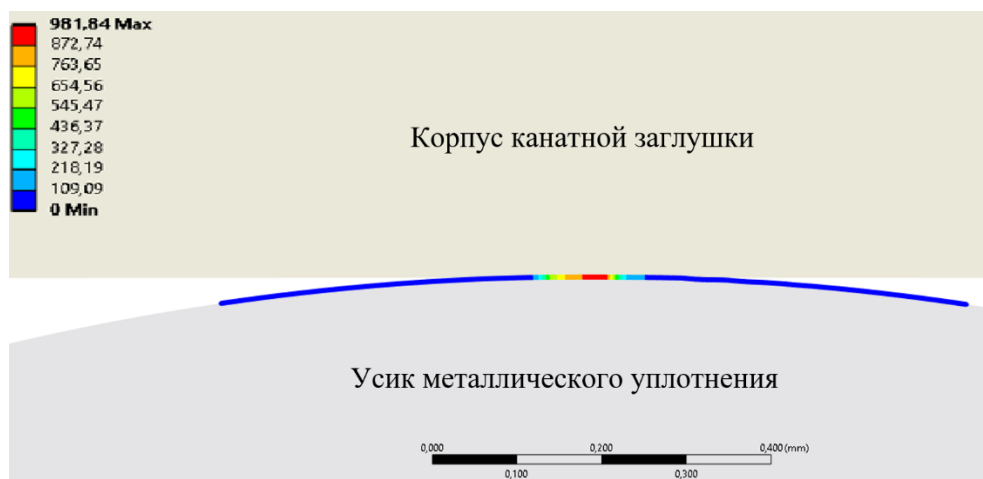
Рисунок 8 – Контактное давление при монтаже металлического уплотнения Figure 8 – Contact pressure when installing a metal seal
