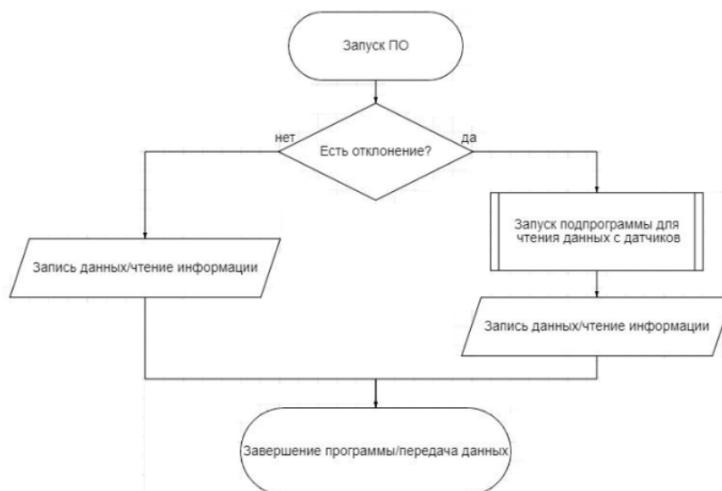
Рисунок 4 – Блок-схема обработки данных Figure 4 – Block diagram of data processing
