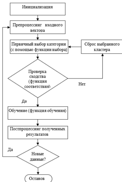
Рисунок 3 – Модель функционала сети семейства ART Figure 3 – Model of the functionality of the ART family network
