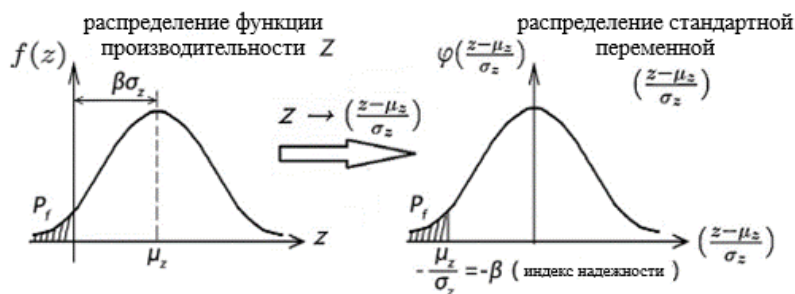
Рисунок 2 – Иллюстрация показателя надежности \beta Figure 2 – Illustration of the reliability index \beta
