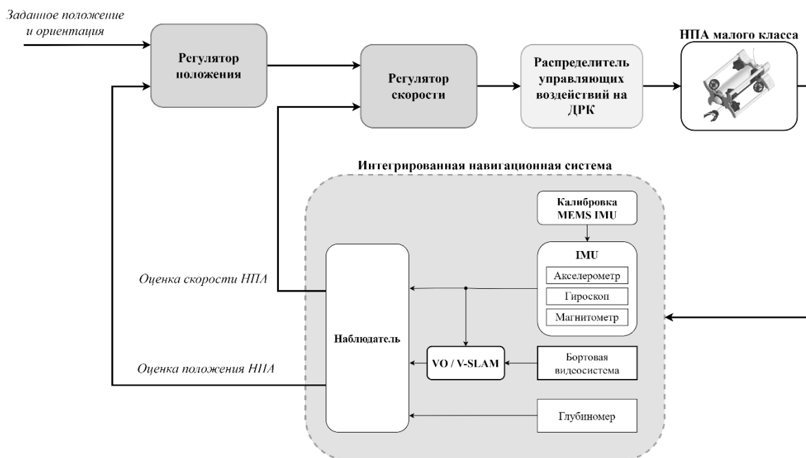
Рисунок 6 – Концепция архитектуры системы ДП НПА малого класса Figure 6 – Concept of the architecture of the small-class DP UUV system
