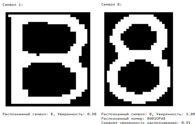
Рисунок 11 – Пример работы разработанного алгоритма
