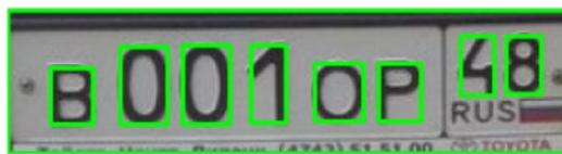
Рисунок 10 – Результат сегментации символов
