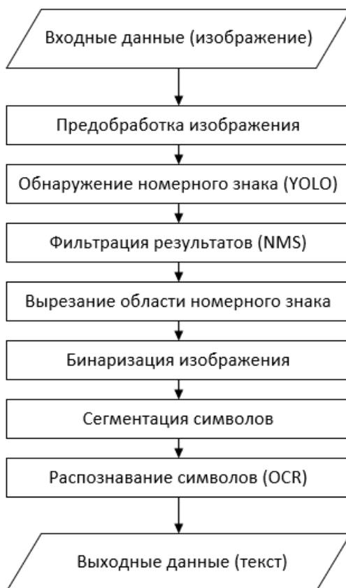
Рисунок 12 – Схема алгоритма распознавания российских автомобильных номеров
