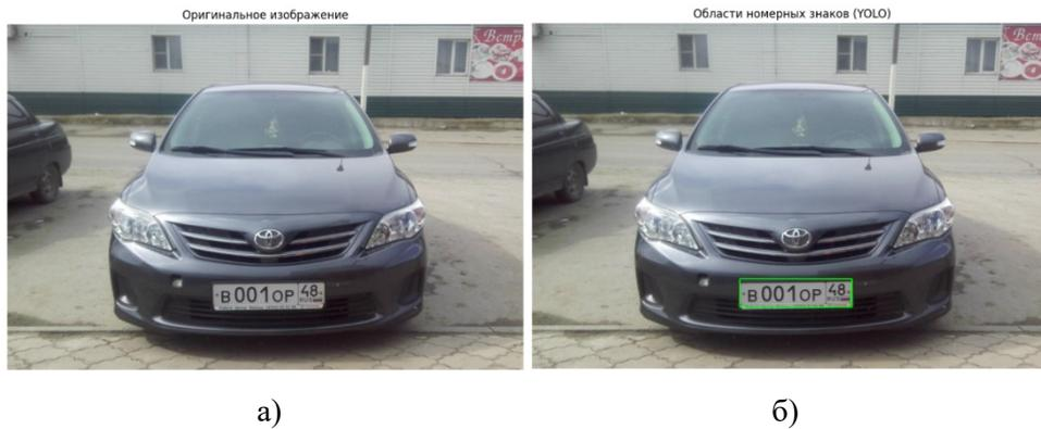
Рисунок 7 – Распознавание автомобильного номера: а) пример входного изображения; б) результат обнаружения
