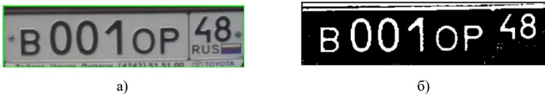
Рисунок 8 – Обработка изображений: а) результат удаления избыточных фрагментов изображения; б) результат бинаризации изображения
