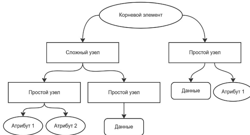
Рисунок 4 – Структура схемы объекта метапространства Figure 4 – Structure of metaspaces object scheme
