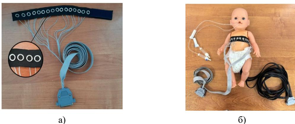
Рисунок 5 – Неонатальная электродная система: а – готовое изделие; б – ЭС Neo, расположенная на кукле-новорожденном
