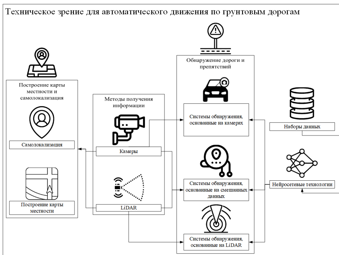
Рисунок 3 – Взаимосвязь технологий и подтехнологий для систем технического зрения, адаптированных для грунтовых дорог
