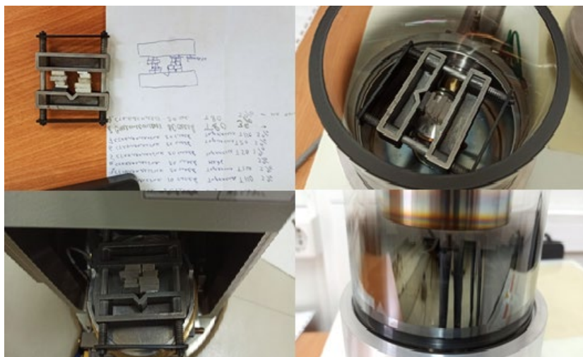
Рисунок 1 – Подготовка срезов образцов для растровой электронной микроскопии Figure 1 – Preparation of sample sections for scanning electron microscopy
