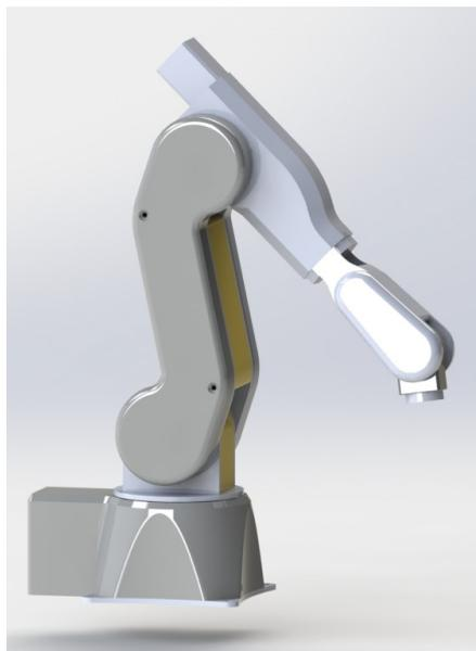
Рисунок 1 – САД модель 6-осевого робота
