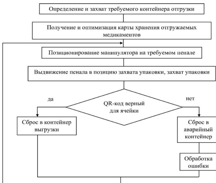
Рисунок 6 – Алгоритм автоматической выгрузки
