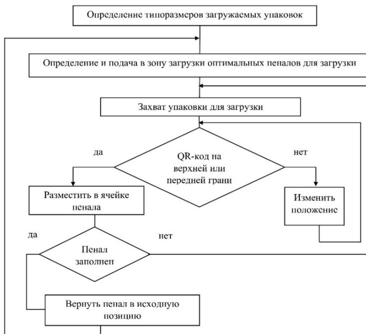
Рисунок 5 – Алгоритм автоматической загрузки
