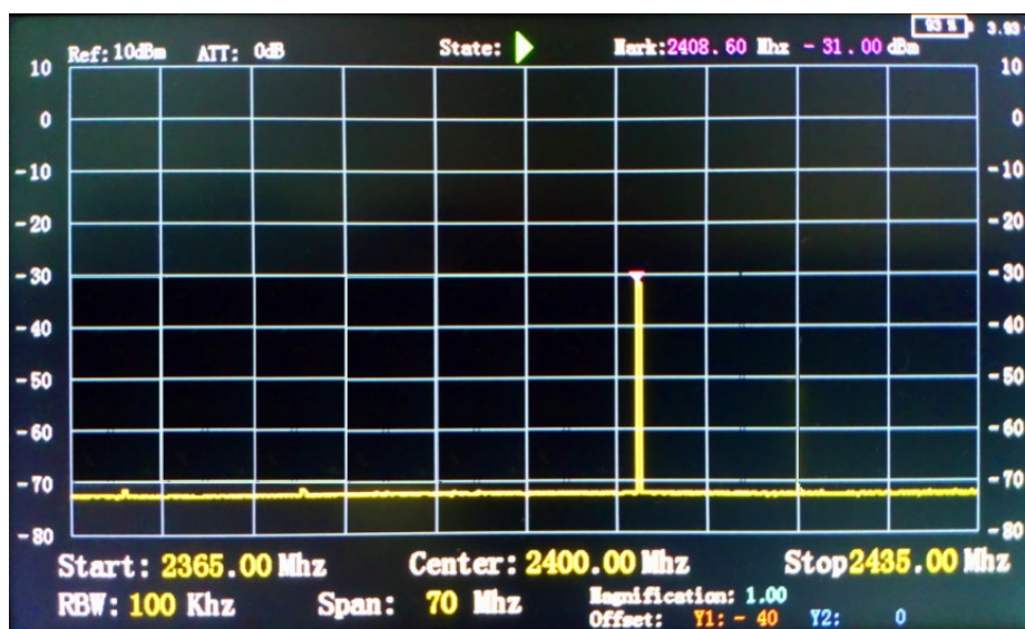
Рисунок 3 – Пояснение к определению отношения сигнал-шум с помощью спектрометра Figure 3 – Explanation of the determination of the signal-to-noise ratio using a spectrometer
