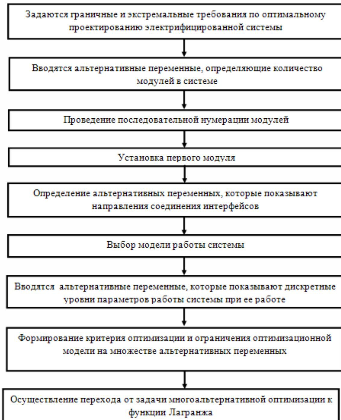
Рисунок 1 – Структурная схема формирования многоальтернативной оптимизационной модели структурного синтеза электрифицированной системы
