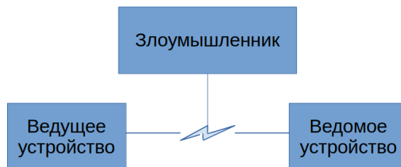
Рисунок 5 – Схема атаки на режим RTU протокола Modbus Figure 5 – Scheme of attack on RTU mode of Modbus protocol
