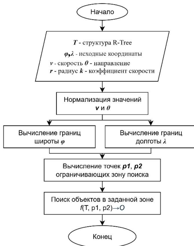
Рисунок 1 – Алгоритм адаптивного геопоиска с учетом скорости и направления движения Figure 1 – Adaptive geospatial search algorithm with movement speed and direction parameters
