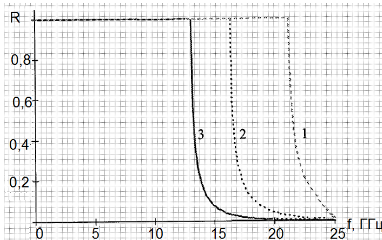
Рисунок 3 – График зависимости показателя отражения от частоты внешнего электромагнитного излучения и уровня фрактальности элемента решетки Figure 3 – Graph of the dependence of the reflection index on the frequency of external electromagnetic radiation and the fractal level of the lattice element
