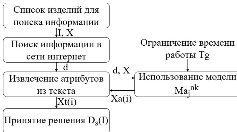
Рисунок 1 – Схема работы поискового агента в соответствии с моделью Figure 1 – The search agent's operation scheme according to the model
