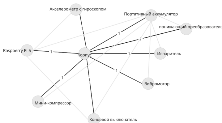
Рисунок 5 – Структурная схема соединений системы XR-тренажера в виде сетевого графа Figure 5 – Structural diagram of the system connections for the XR-simulator in the form of a network graph
