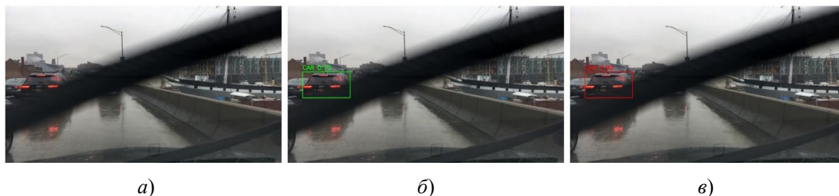
Рисунок 1 – Сценарий частичного перекрытия объекта: a – исходное изображение; б – результат распознавания YOLO без учета сложного условия; в – результат распознавания с учетом сложного условия, предварительно определенного МЭС Figure 1 – Partial object occlusion scenario: a – original image; b – YOLO detection result without using the challenging condition; c – detection result using the challenging condition preliminarily identified by the MES
