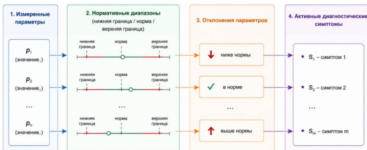
Рисунок 2 – Формирование диагностических симптомов на основе отклонений параметров Figure 2 – Formation of diagnostic symptoms based on parameter deviations
