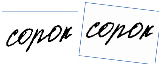
Рисунок 3 – Коррекция искажений поворотом изображения вокруг своей оси
