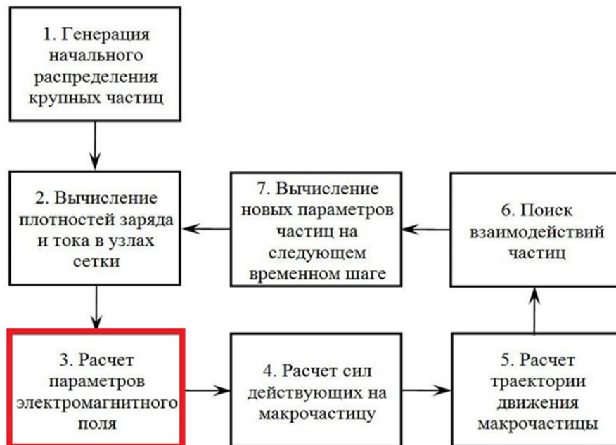
Рисунок 2 – Пример использования метода КЧ к решению задачи электродугового синтеза Figure 2 – An example of applying the large-particle (PIC) method to solve the electric arc synthesis problem
