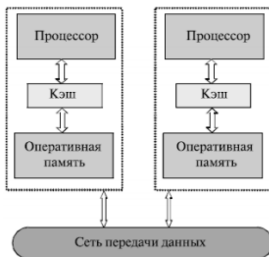
Рисунок 3 – Архитектура вычислительных систем, имеющих распределенную память.
