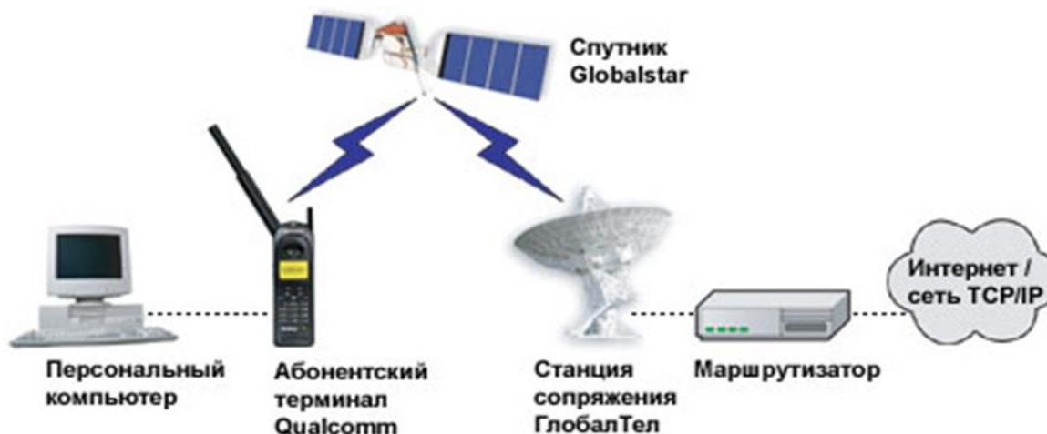
Рисунок 1 - Типичная схема услуг связи (голос, передача данных) с АТ Qualcomm (GSP 1600)
