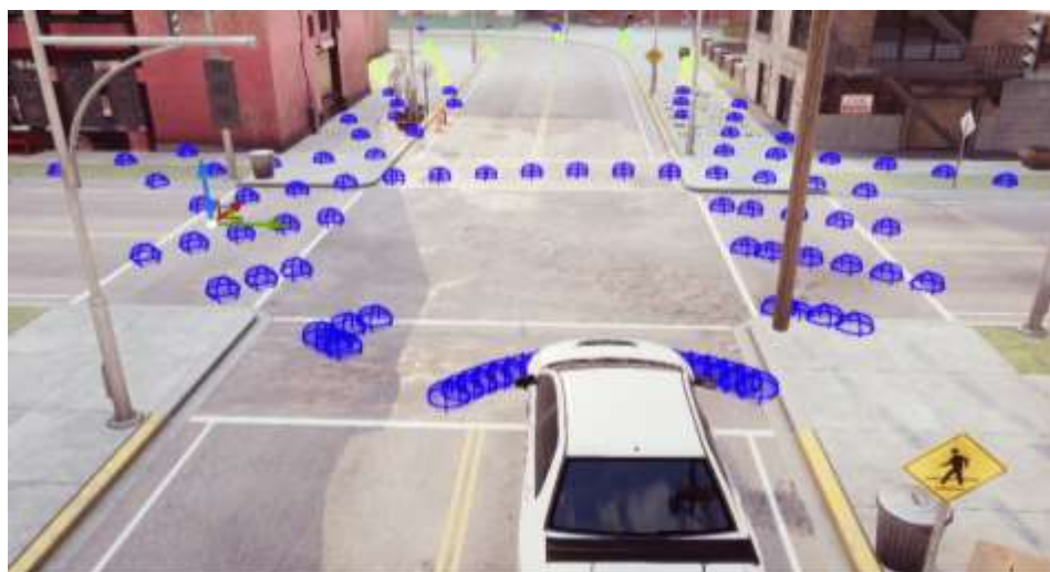
Рисунок 4 - Визуализация работы EQS-запроса поиска точки перемещения ИИ
