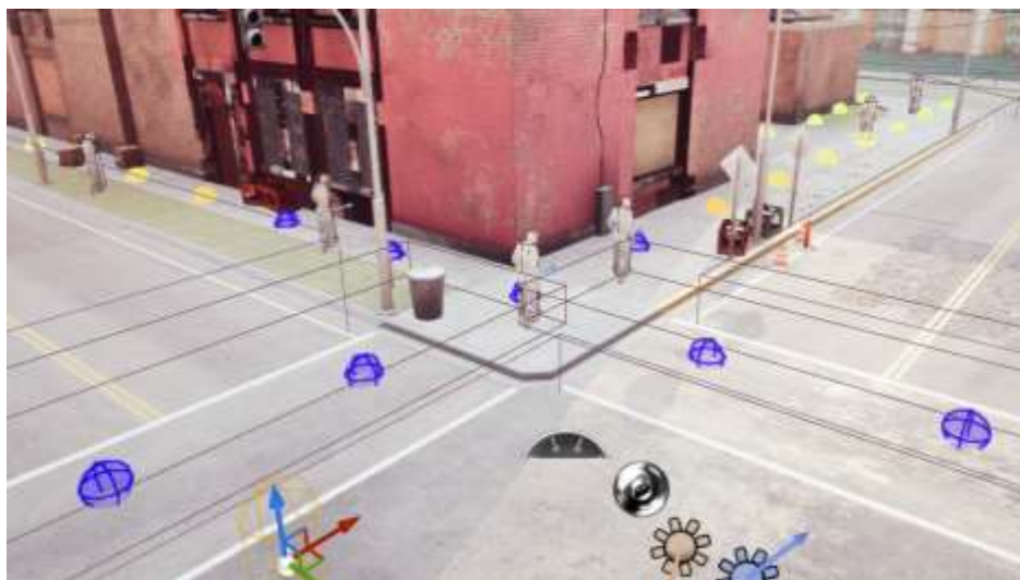
Рисунок 5 - Визуализация работы EQS-запроса поиска точки назначения движения ИИ
