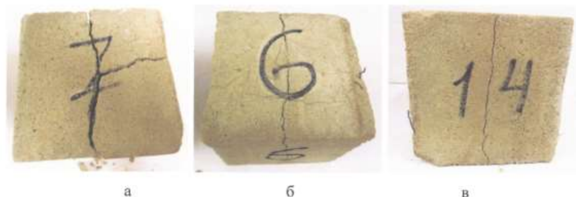
Рисунок 7 - Вид образцов выдержанных дополнительно в печи: а - серии 1, б - серии 2, в - серии 3
