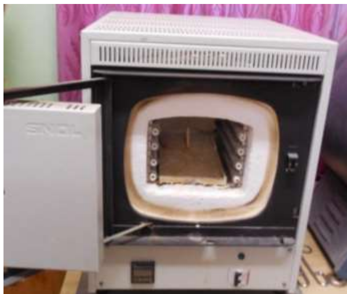
Рисунок 1 - Вид применяемой муфельной печи «Снол»
