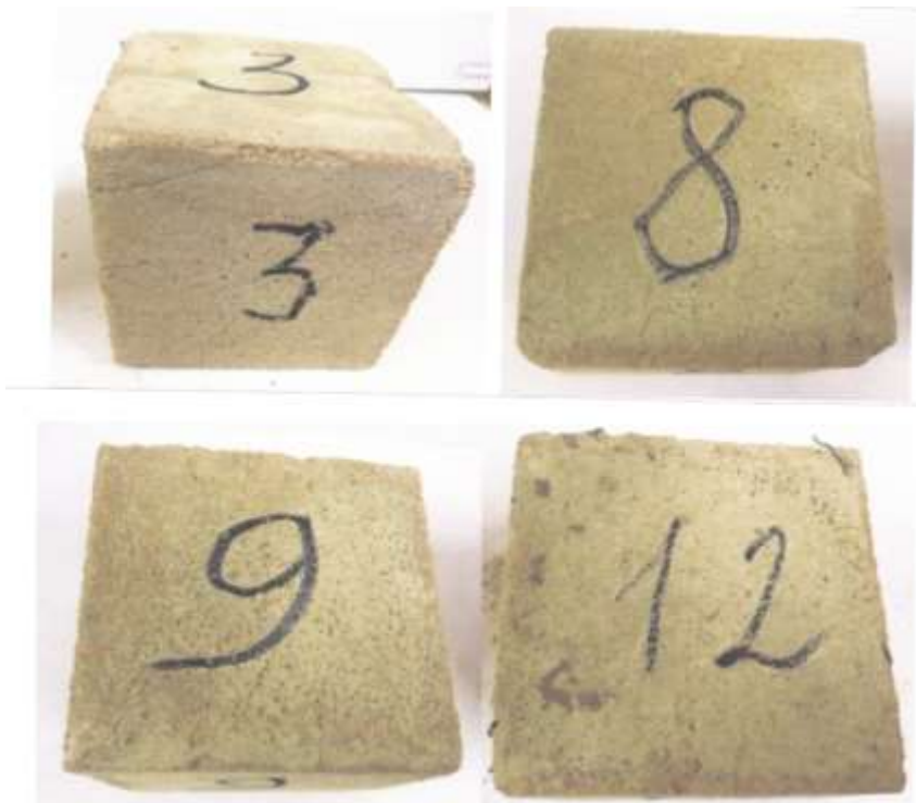
Рисунок 6 - Вид образцов с 2% фибр после испытаний
