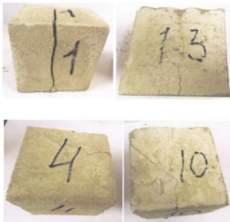
Рисунок 4 - Вид образцов без фибр после испытаний
