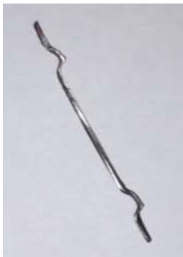
Рисунок 2 - Вид фибры используемой в эксперименте
