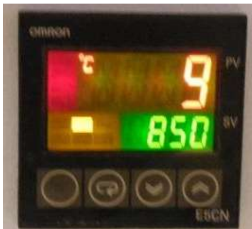
Рисунок 3 - Вид цифрового табло муфельной печи
